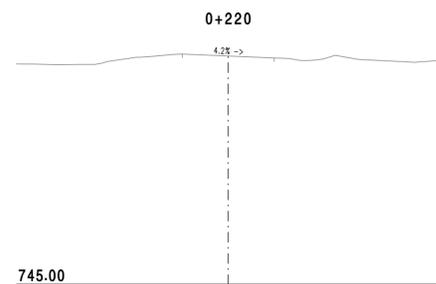
Die Gradientenberechnung und die Darstellung der bestehenden Querneigung wurde aus den ausgeglichenen Rasterhöhenwerten des "Digitalen Geländemodells [DGM]" vom Landesamt für Geoinformation und Landentwicklung [LGL] entwickelt.
